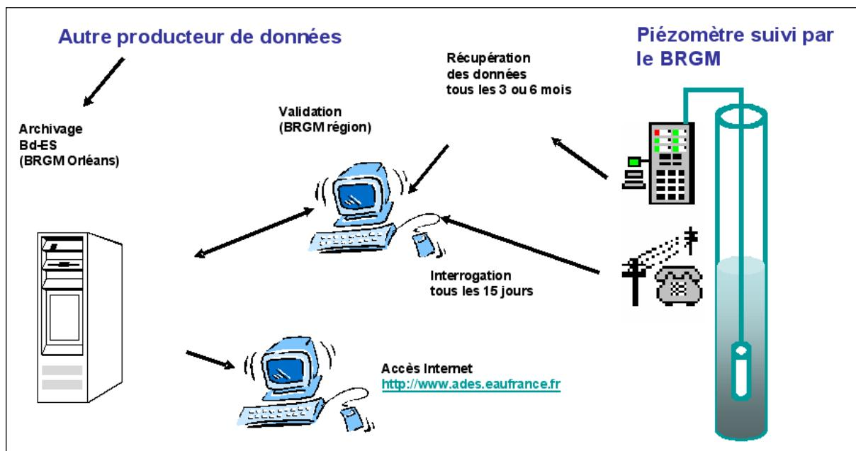
Figure 3 : Circuit de production des données du réseau piézométrique du bassin Seine-Normandie
