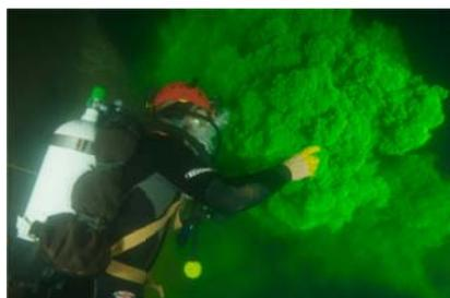
Fig. 1 : Injection de la fluorescéine par les plongeurs
